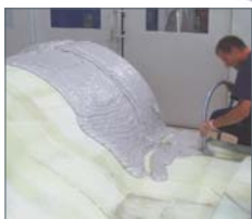
糊状泥涂敷操作
